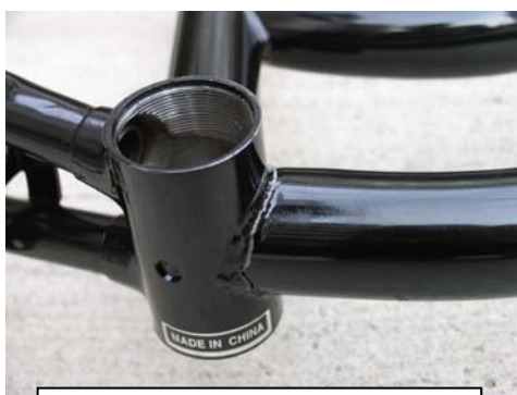
No.25 下パイプ・ハンガ側折損
