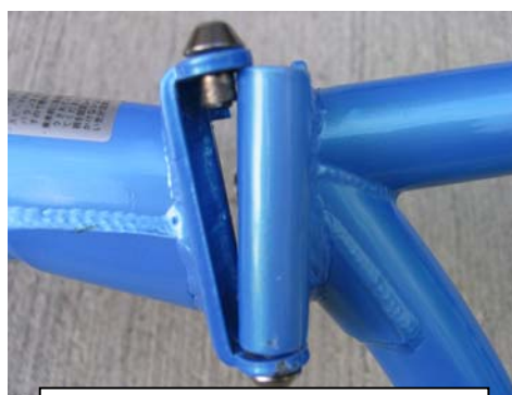
No.29 ジョイント部連結ピン破断
