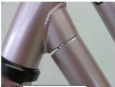
No.07 下パイプ折損
