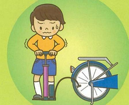
自転車用タイヤバルブ(空気を入れる部分の弁)のゴムが劣化し、空気が入らなくなることがあります。握りを押し下げる力が極端に重いときは、蓄圧タンクの内圧が高まり、飛び出す危険があるので、無理に空気を入れず自転車店などで点検してもらいましょう。
