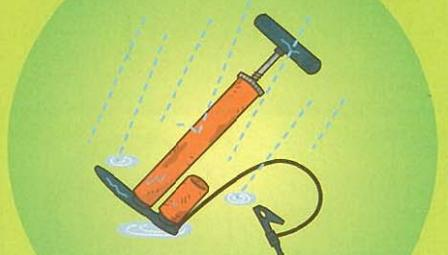
保管場所は取扱方法に従い、雨ざらしや直射日光が当たる場所を避けましょう。シリンダ本体が金属製のものは雨ざらしにすると内部に雨水が入り、腐食して強度に影響を与える場合があります。また、直射日光の下では、紫外線によりプラスチックが劣化することがあります。
