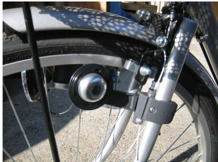
②打子がリムに衝突する際の雑音がベルの音色を汚し、乱暴な印象を与えていた。
