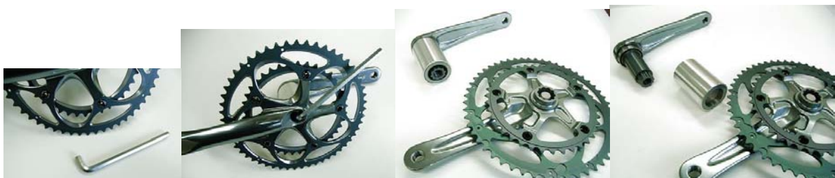
ヘキサゴンレンチ1本で取り付け、取り外しが可能
