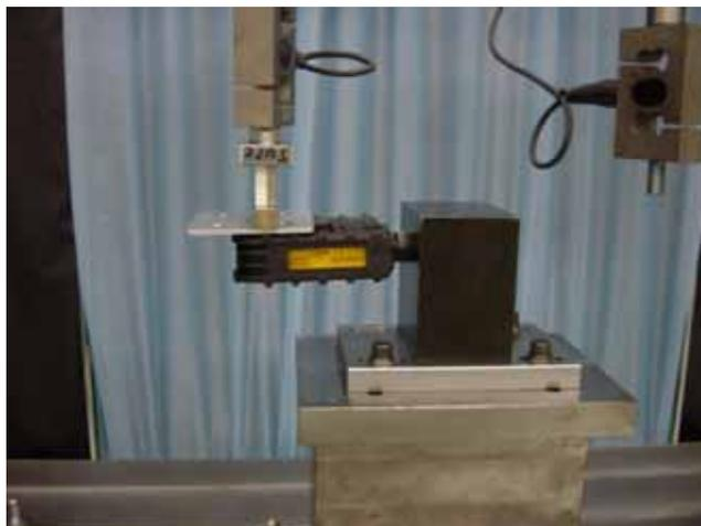
写真 4 ペダルの繰返し強度試験
