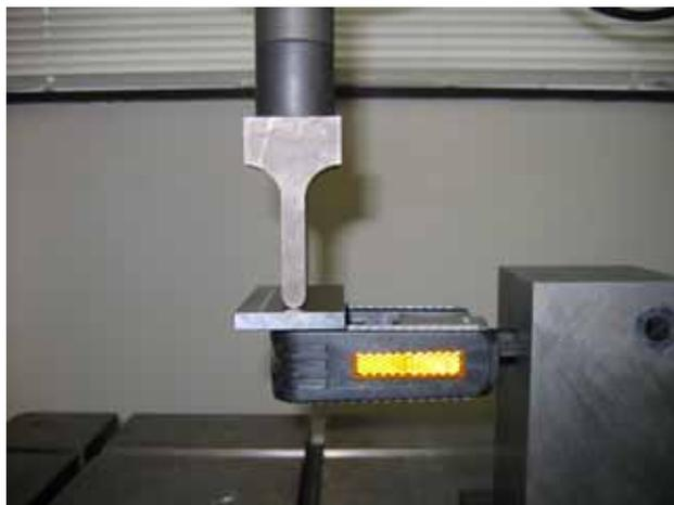
写真 3 ペダル先端部の静的強度試験
