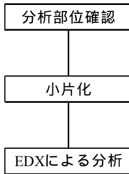
図 6 EDX による測定分析方法のフローチャート
