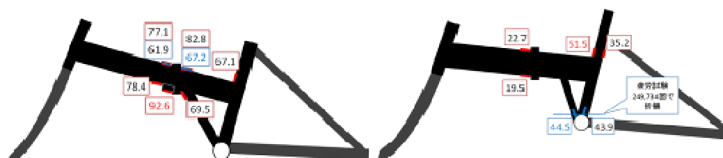
図 45 ハンガ上に補強パイプ、立パイプが溶接されているフレーム
