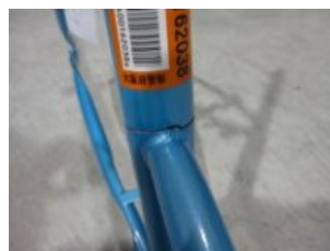
立パイプ亀裂
