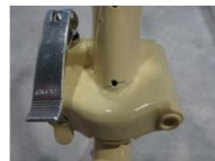
ヒンジ接合部亀裂
