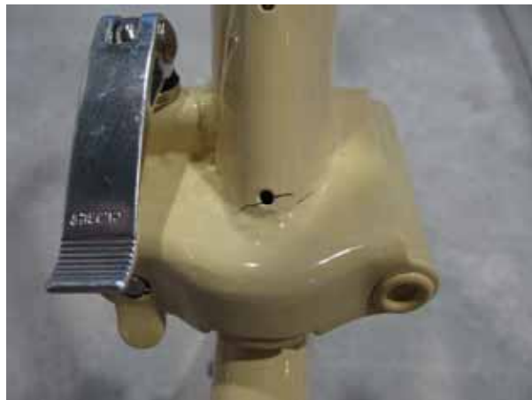
12 ヒンジ接合部亀裂
