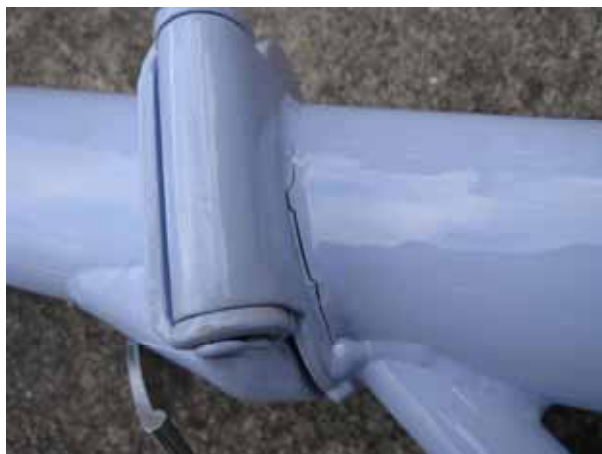
6 ヒンジ接合部亀裂
