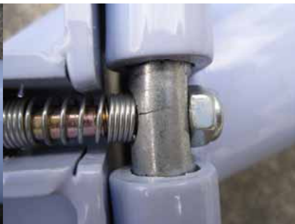
6 ロッドピン亀裂
