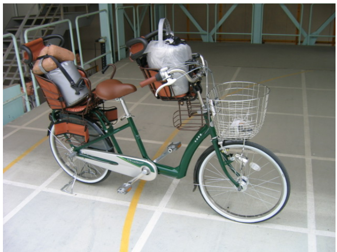
写真 5-6 駐輪時の安定性試験状況
