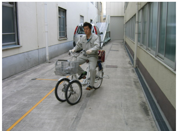
写真5-5 走行中の振動試験状況
