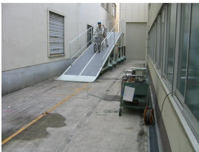
写真5-1 制動性能試験状況
