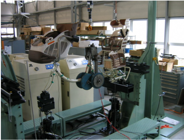
写真 2-2 ハブ軸固定による試験状況
