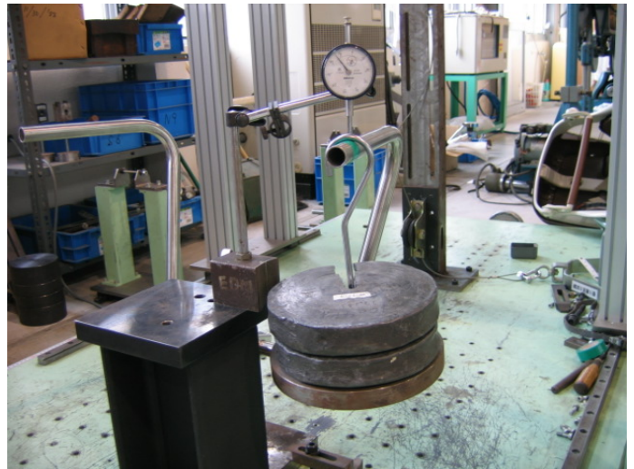
写真5-4 ハンドルの剛性試験状況
