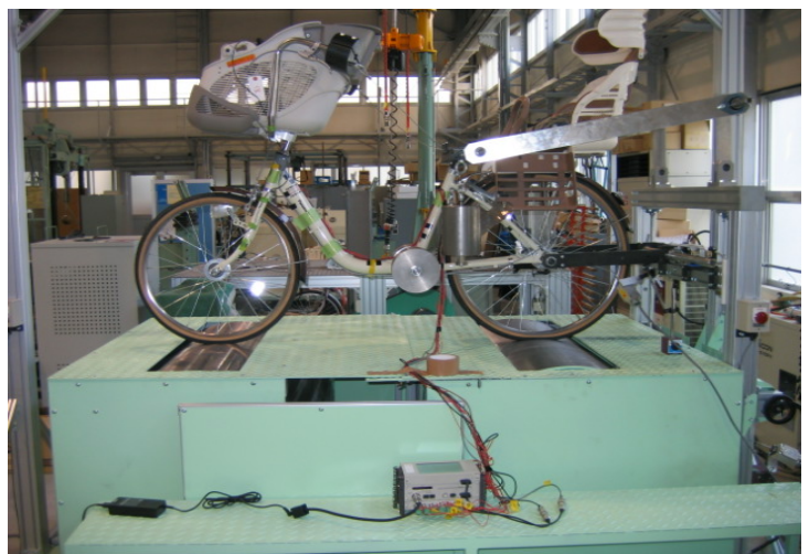
写真3-1 Wドラム試験機による試験状況
