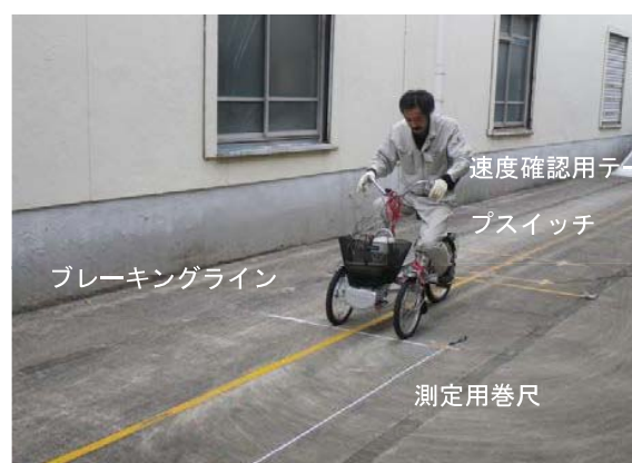
写真5 制動性能試験状況
