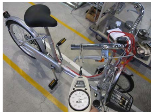
写真2 ハンドル操舵力測定状況
