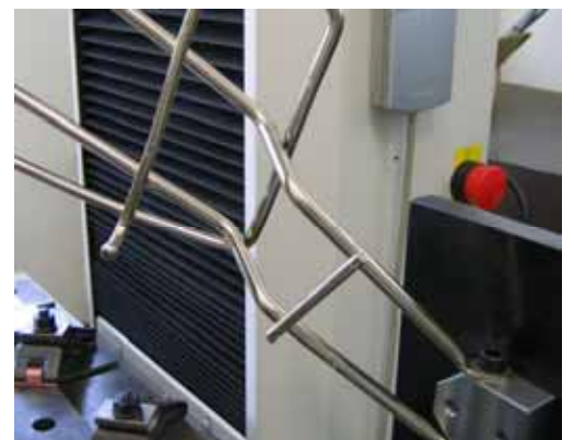
写真 4.4-2 リヤキャリア破損状況
