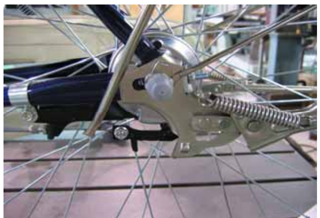
写真 4.6-2 リヤキャリアステア破損状況
