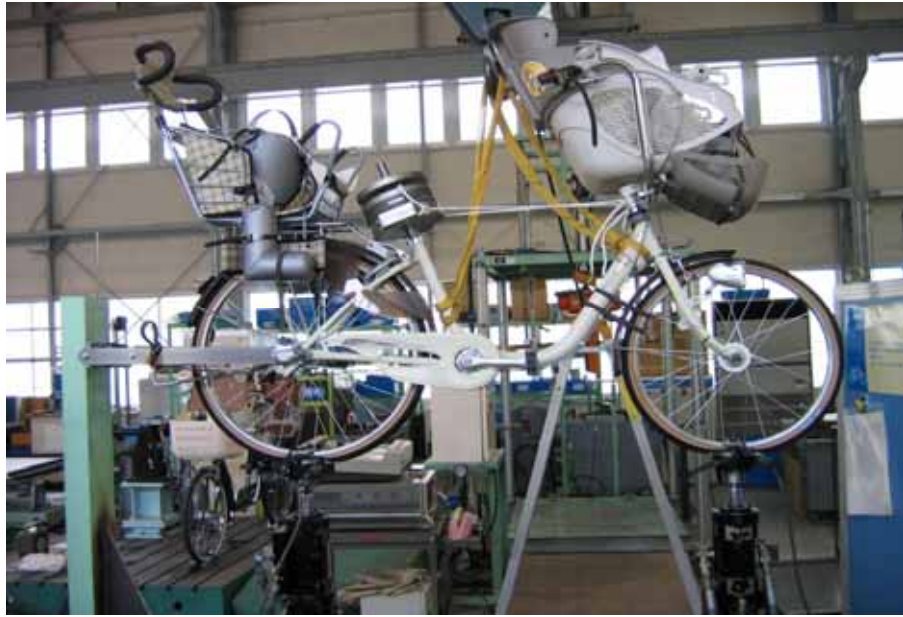
写真 4.5-1 上下加振強度試験状況
