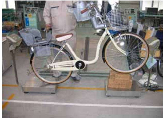
写真 4.1-1 分担荷重計量状況
