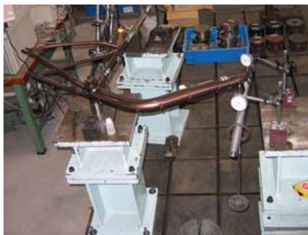
写真 4.7-1 フレーム体ねじり剛性測定状況
