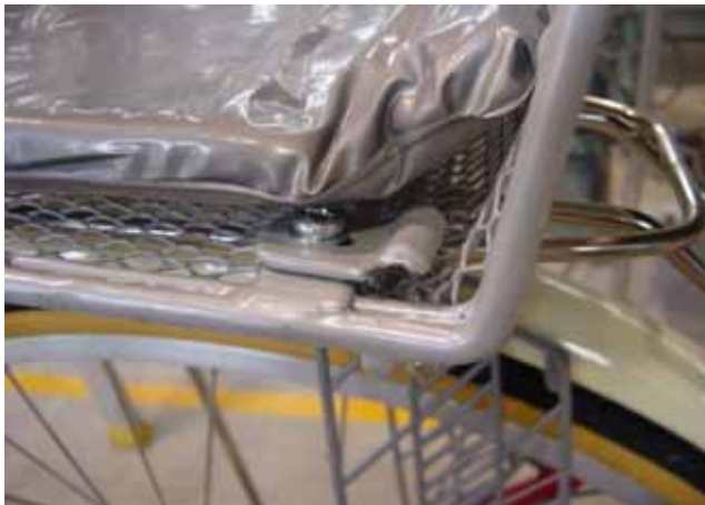
写真 4.5-2 足乗せ部破損脱落状況
