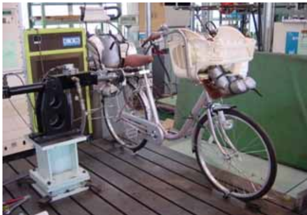
写真 4.6-1 揺動試験状況
