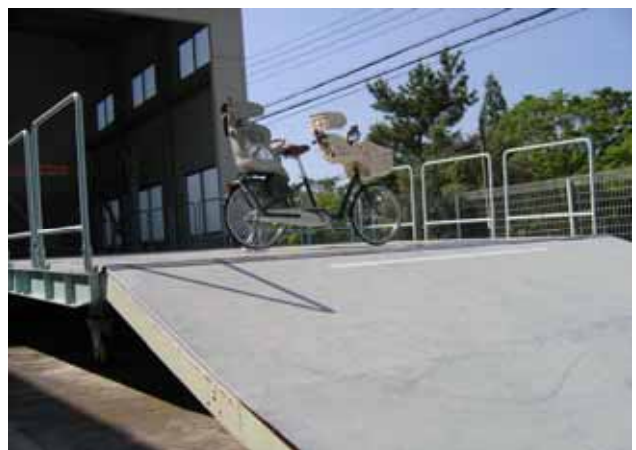
写真 4.2-2 静的安定性試験状況
