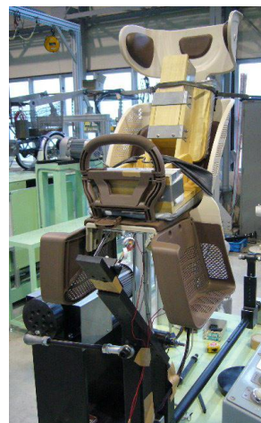
写真19 キャリヤ単独による 試験状況（ダミー）
