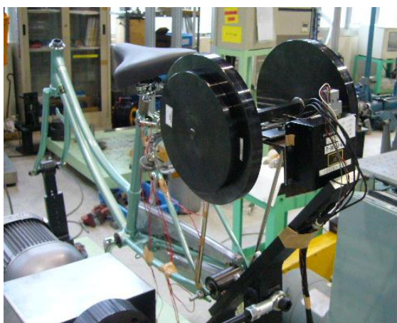
写真16 フレームとキャリヤの組み合わせによる試験状況（ダンベル）
