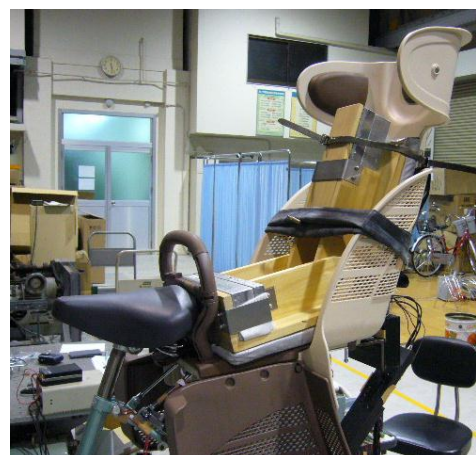
写真17 フレームとキャリヤの組み合わせによる試験状況（ダミー）
