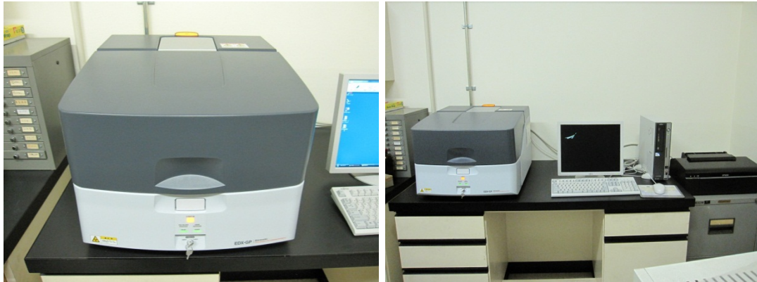
写真 エネルギー分散型蛍光X線分析装置（左：本体 右：システム全体）
