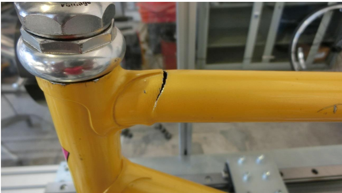
写真 7 試験後の様子（上：前三角の折損と変形、下：上パイプ折損部）
