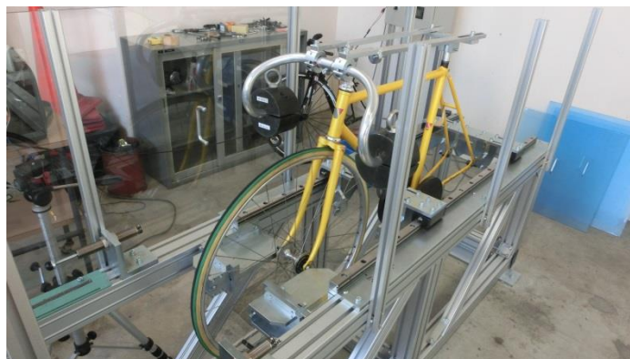
写真 3 完成車衝突試験の様子
