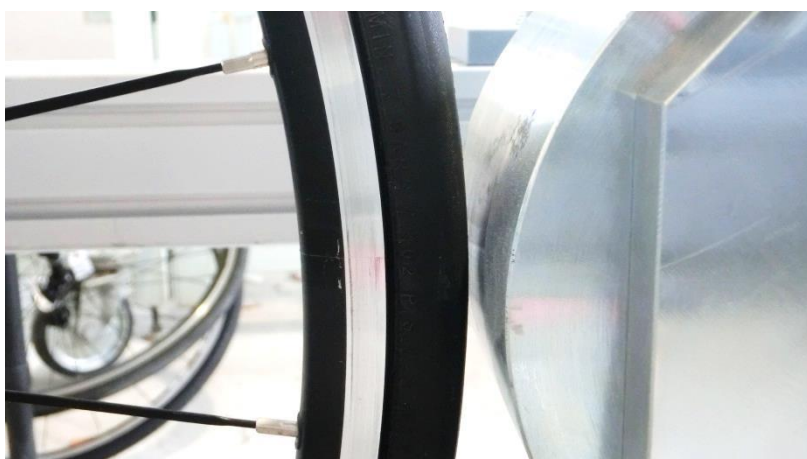
写真 2 衝撃付与箇所（リムの継ぎ目が衝突箇所正面に配置）
