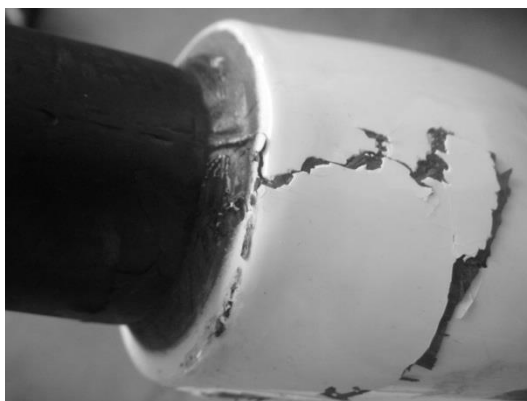
写真 6 ロード No. 4 2 回目の後方衝撃試験後のホーク肩付近の様子
