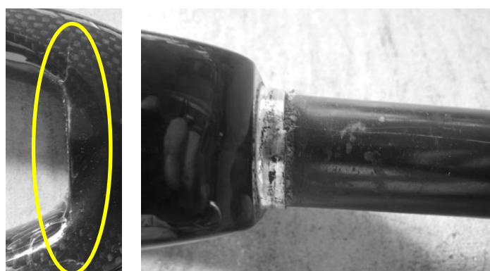
写真 12 BMX No. 1 後方衝撃試験後 (左 : ホーク足、右 : ホークステム根元)
