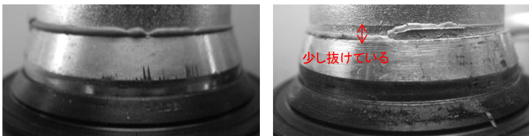
写真 3 後方衝撃試験前後でのホークステム根元（左：新品状態、右：試験後）
