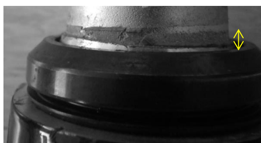
写真 5 ロード No. 3 2 回目の曲げ疲労試験中断時
