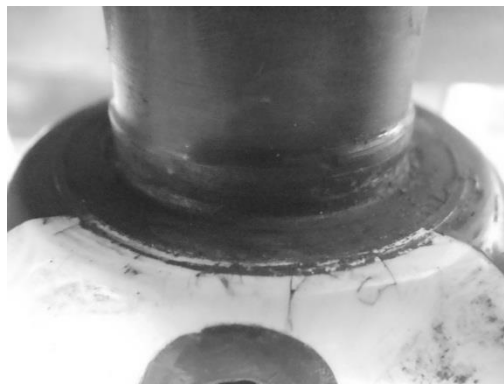
写真 9 ロード No. 6 曲げ疲労試験たわみ量 20%を超えたときの様子
