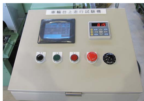
写真4 制御装置（操作盤）
