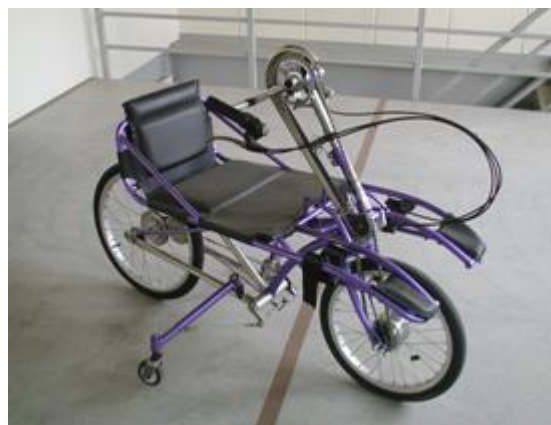
図 3 クランク駆動式 2 輪アームサイクル
