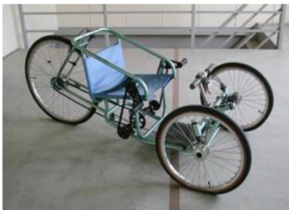
図 2 クランク駆動式 3 輪アームサイクル
