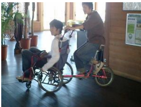
図 4 車いすに自転車を合体した乗り物：トランスポートビークル 大分県田ノ浦ビーチ公園での利用状況（当時のHPより）
