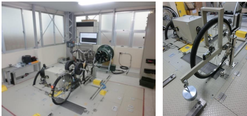
写真 1 シャーシダイナモメータとアタッチメント取付例
