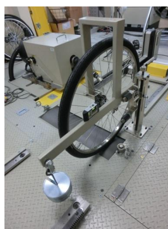
写真 1 シャーシダイナモメータとアタッチメント取付例
