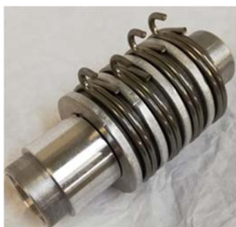
シャフト組み付け状態
