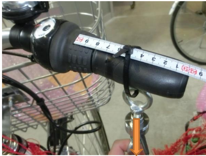
図 3 変換係数を求めるため力を付加する様子
