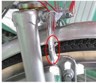
図1 ひずみゲージ貼り付け位置
