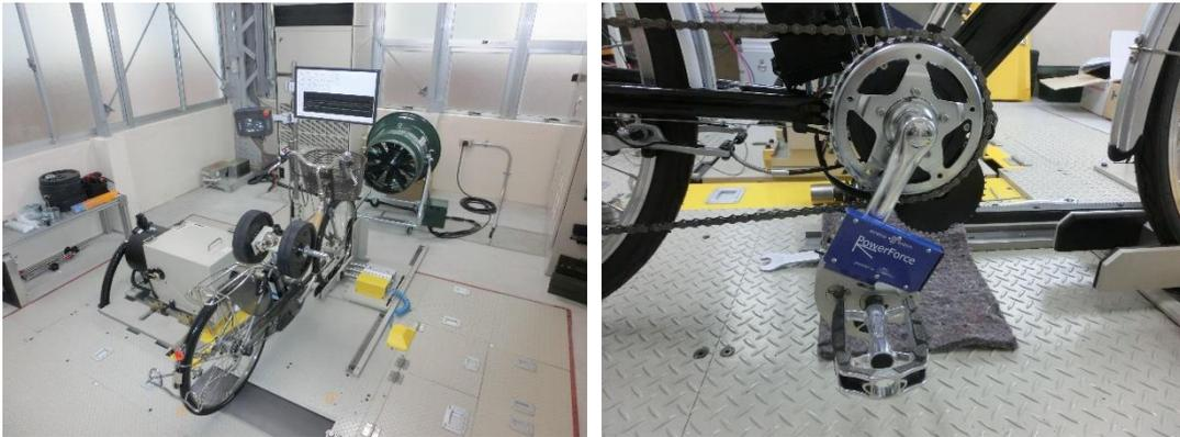
写真 1 測定機器外観 (左：シャーシダイナモメータ、右：ペダルセンサー)
