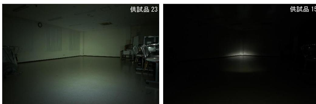
写真 6 最大光度 2,230 cd (左) と 2,880 cd (右) の水平面への照射
