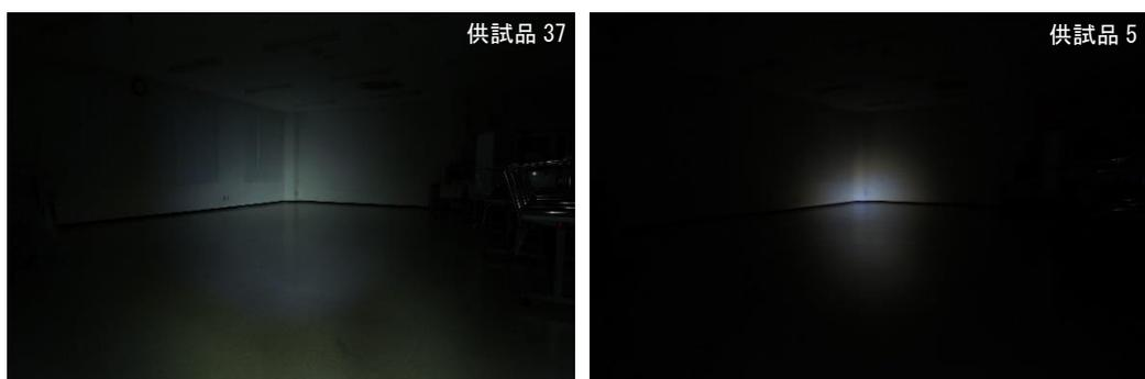
写真8 全光束 100 lm、照射角 20°（左）と 90 lm、10°（右）
