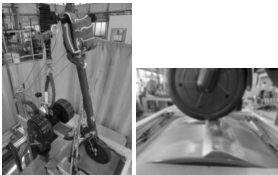
写真 14 疲労試験（動的） 試験時の様子（左：全景、右：段差乗り越え時の様子）
