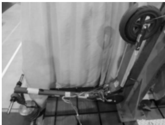
写真 7 ハンドルバー及びステアリングコラムー曲げ試験（前方） 試験時の様子
