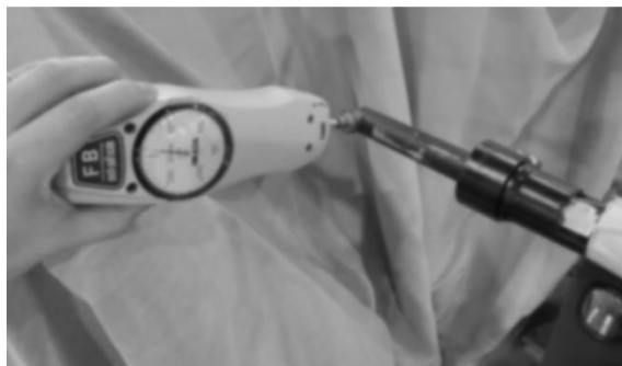
写真 10 ハンドルバー及びステアリングコラムトルク試験 試験時の様子
