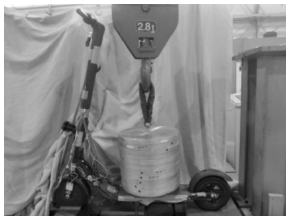
写真 5 静荷重試験—デッキ／フレーム 試験時の様子
