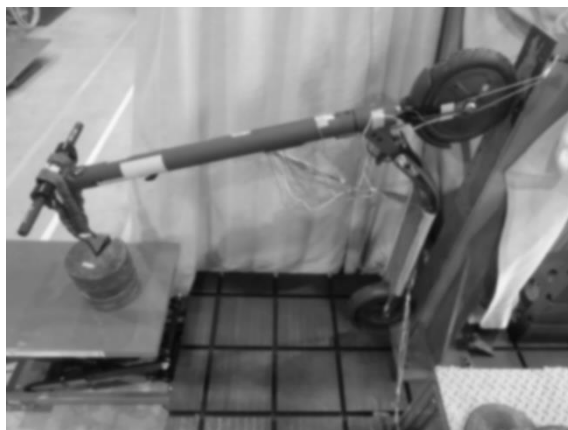
写真 6 ハンドルバー及びステアリングコラムー曲げ試験（後方） 試験時の様子
