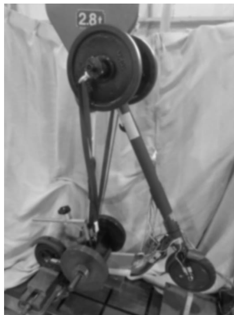
写真 13 前方衝撃耐性試験 試験時の様子
