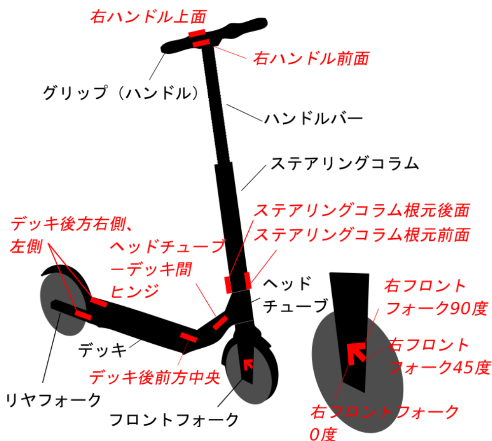
図 1 ひずみゲージの貼付箇所（赤斜字）と主な各部名称（黒字）
