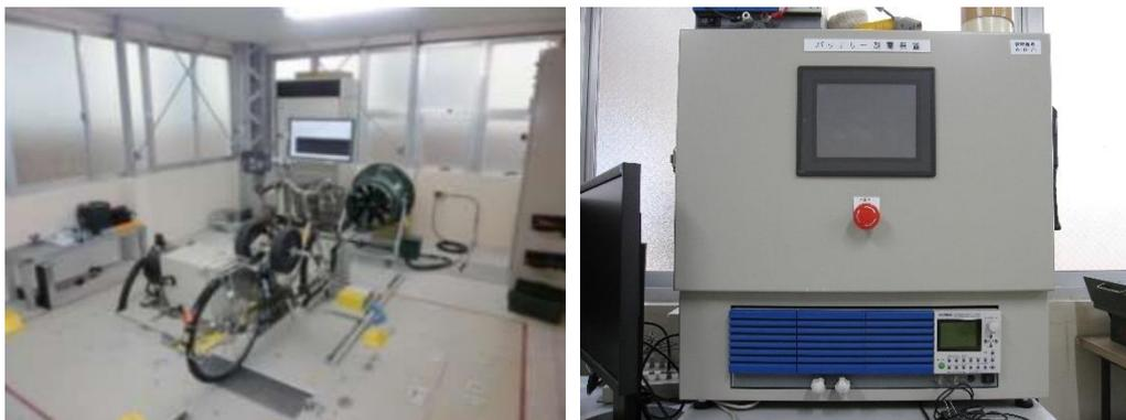
写真2 シャーシダイナモメータとバッテリー放電装置
