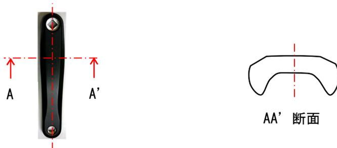
**図 7** 供試品 No.4 のアーム部の断面形状
