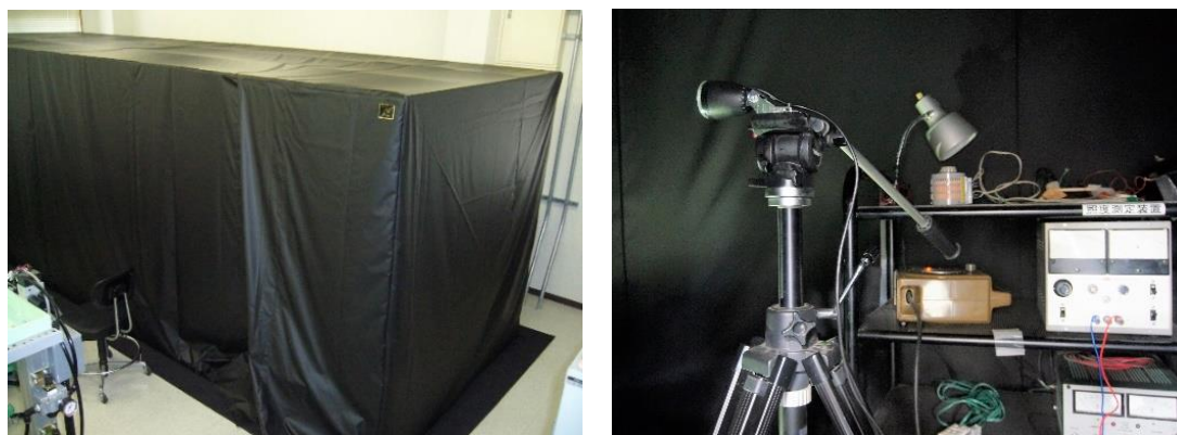
写真 1 暗室と照度測定システム
